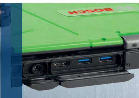
Conexión USB protegida para pendrives
